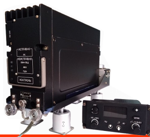
Бортовая приёмно-передающая радиостанция МВ диапазона «Орлан-85Ст»
